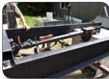
Retrofit bracket testing per AC358
